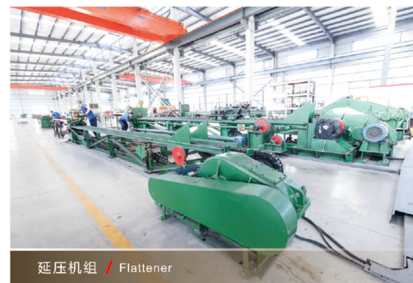
延压机组 / Flattener
